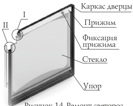
Рисунок 14. Ремонт светопрозрачного экрана двери модели «Витра»
